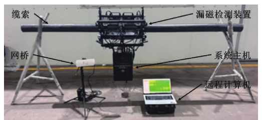
(a) 桥梁缆索漏磁检测实验平台
